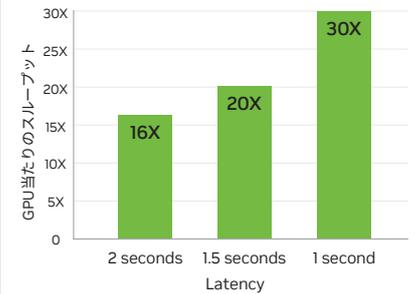
入力シーケンス長を128、出力シーケンス長を20としたときの Megatron 5,300 億パラメーター モデル チャットボットによる推論 | A100クラスター: HDR IB ネットワーク | H100 クラスター: 16 基 H100 構成の NDR IB ネットワーク | 32 基 A100と16 基 H100 の1秒および 1.5 秒での比較 | 16 基 A100と16基H100の2秒でん比較
